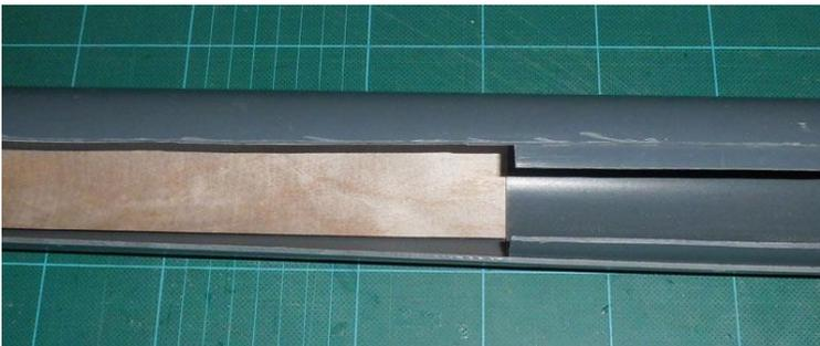
Nach trocknen und ausschleiben aus die Rohre steht das Dach schon rund.
