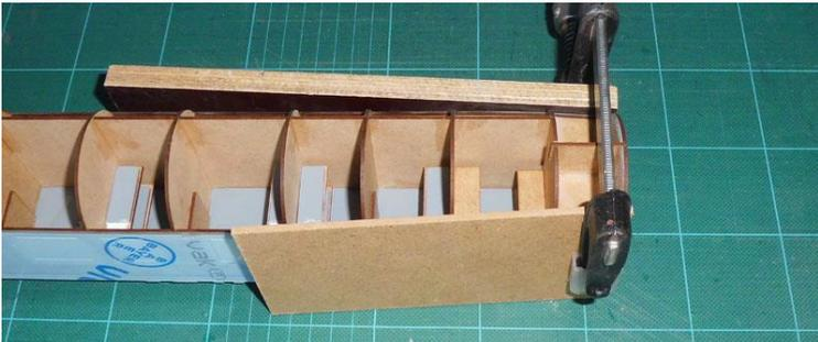
Die Dachhaube wird beigeschnitten und auf die MDF Struktur geklebt.
