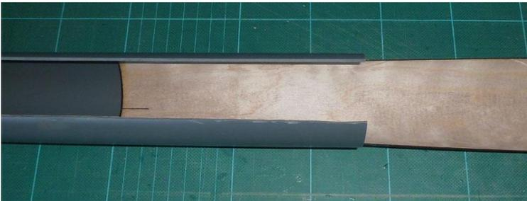
Jetzt werden die zwei Schichte Triplex auf einander geklebt und in das gleiche Rohr geschoben, und mit einem zweiten Rohr mit gleichem Durchmesser zusammen gepresst.
